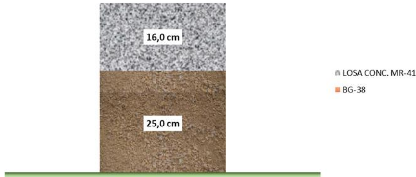
Figura 3-15: Espesores de pavimento rígido
